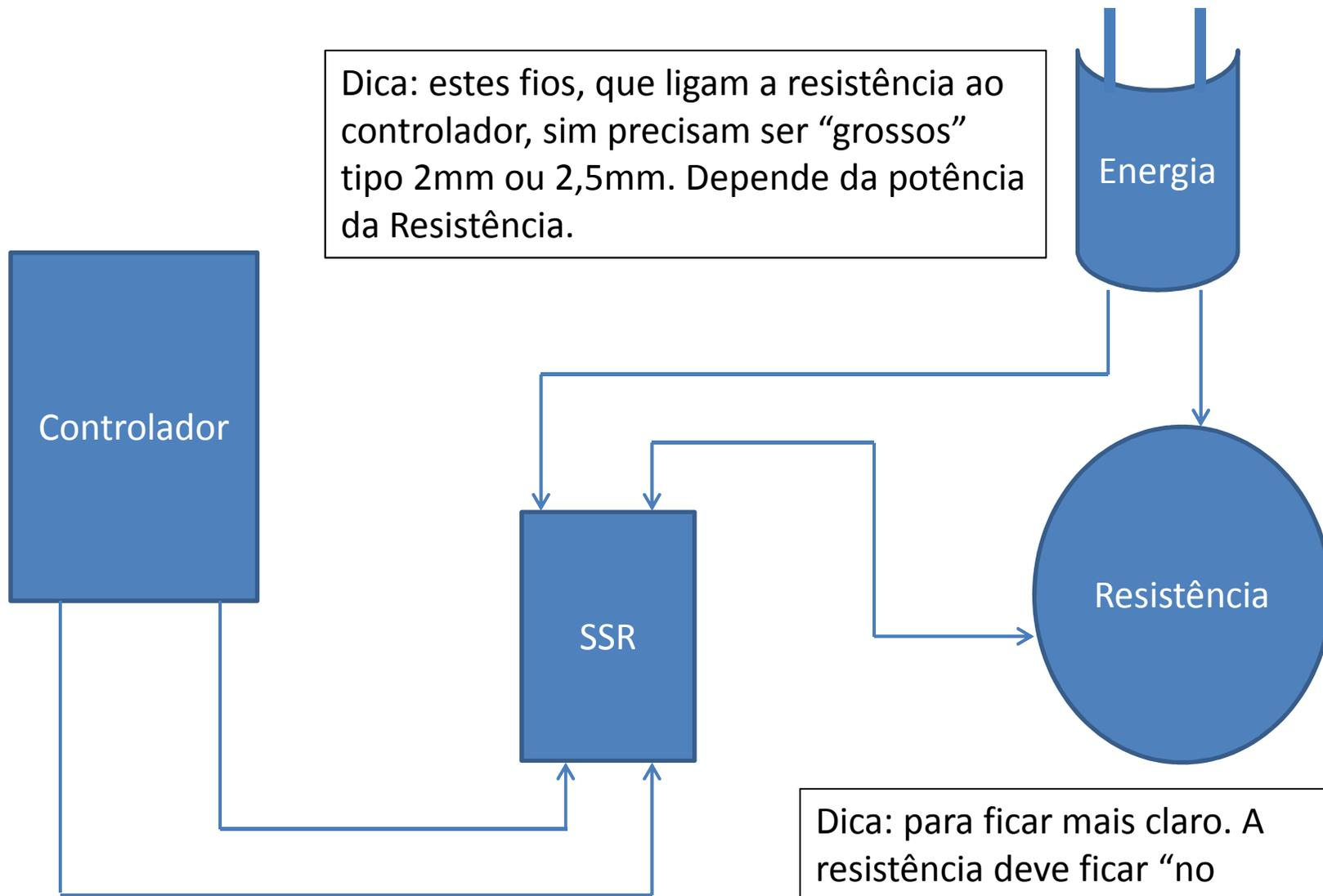
Dica: estes fios, que ligam a resistência ao controlador, sim precisam ser “grossos” tipo 2mm ou 2,5mm. Depende da potência da Resistência.
